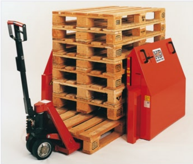
Das H+D-Palettenmagazin stapelt Leerpaletten auf und ab. Vorteile: Arbeitserleichterung, Platzersparnis, Unfallverhütung, Ordnung.
