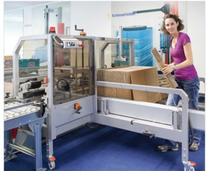
Vollautomatischer Kartonaufrichter mit integriertem Bodenschließer stellt Kartons im Sekundentakt bereit.
