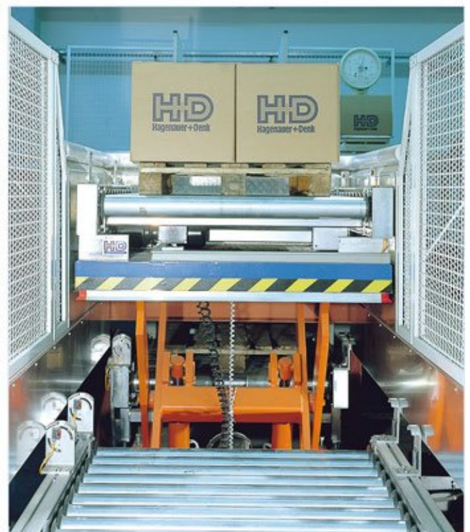
Hand-Palettierplatz auf Podest mit Scherenhubtisch und Palettenrollbahn.
