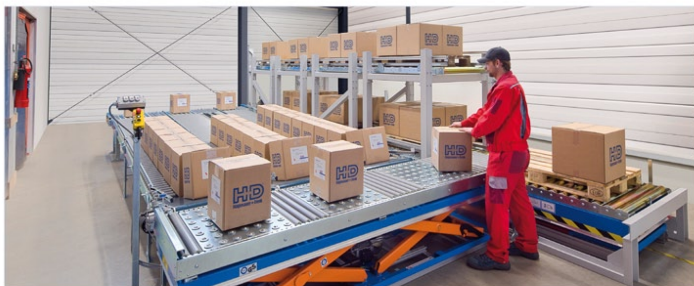
Höhenverstellbarer Wareneingangskontrollplatz für Kartons und Paletten.
