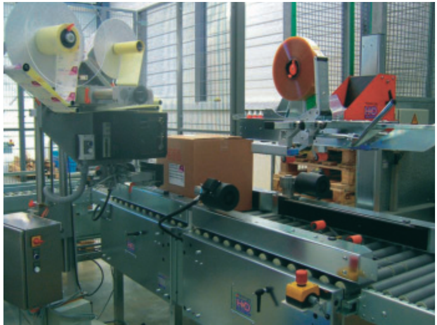
Vollautomatischer Kartonverschluss mit Etikettierstation in Kompaktbauweise.
