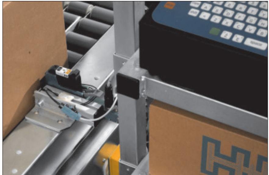
Mittels InkJet wird Kartons die jeweilige Zieladresse aufgespritzt.
