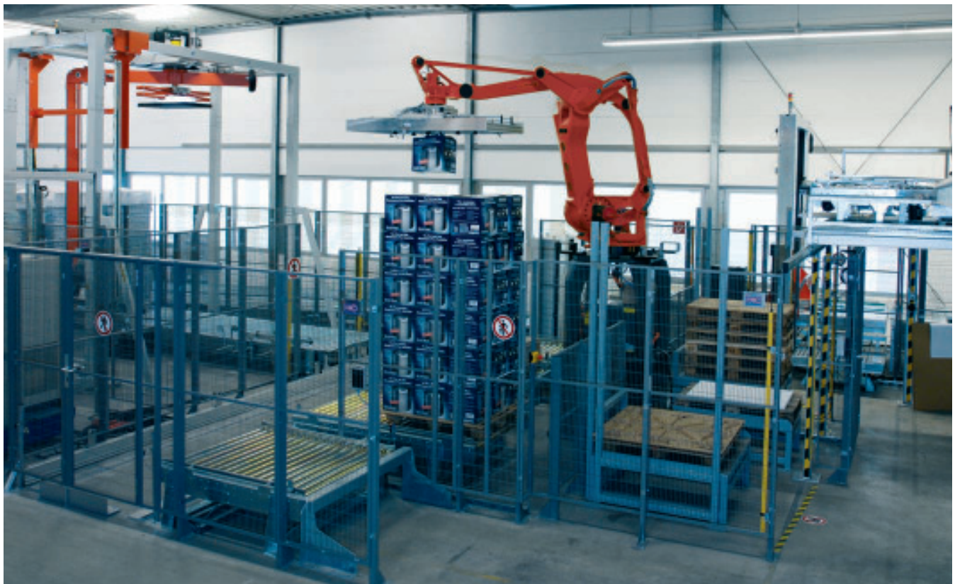
Bis zu 750 Kartons pro Stunde werden über den Knickarm-Roboter palettiert. Ein Hochleistungs-Stretchwickler sichert die fertigen Paletten mit Folie.
