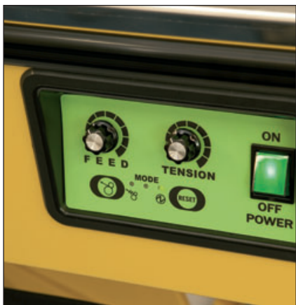
Drehpotentiometer regeln Bandspannung und Bandvorschub
