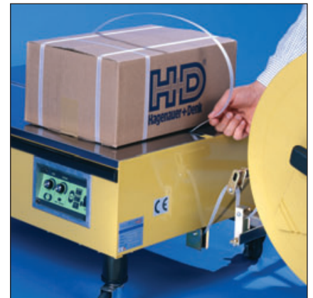
Das Auslösen des Kontaktes im Bandkanal startet den Umreifungsvorgang
