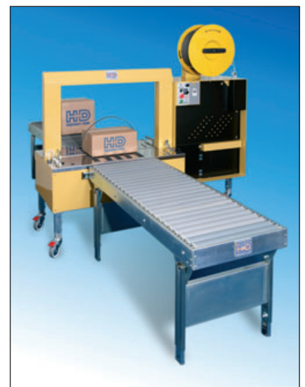
Durch Stellfüße kann das Flachmodell HDS-9 LA der gewünschten Bauhöhe angepasst werden
