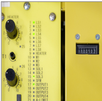
Elektronische Auswerteeinheit mit Umreifungszähler
