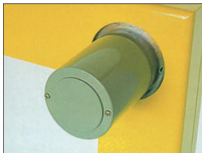
Sicherer Bandvorschub bei großen Rahmen durch zusätzliche Motoren
