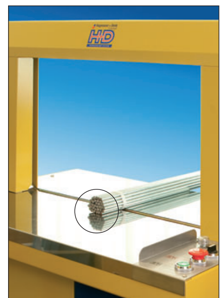
Rundkörper mit nur 80 mm Ø werden umreift
