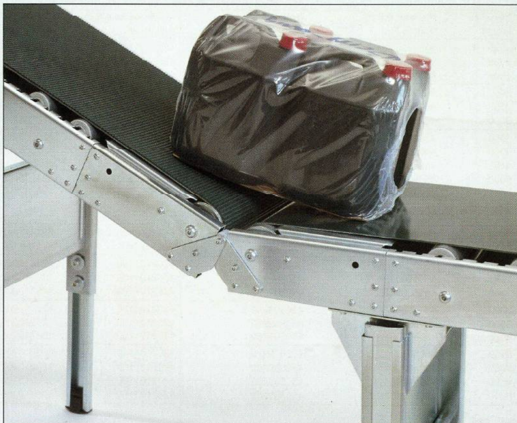
Förderer mit Booster eignen sich dort gut, wo der Übergangswinkel groß ist.
