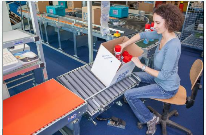
Der Kipptisch in horizontaler bzw. gekippter Position. Je nach Tischtyp ist die Fahrrichtung gerade, vorwärts oder seitwärts.
