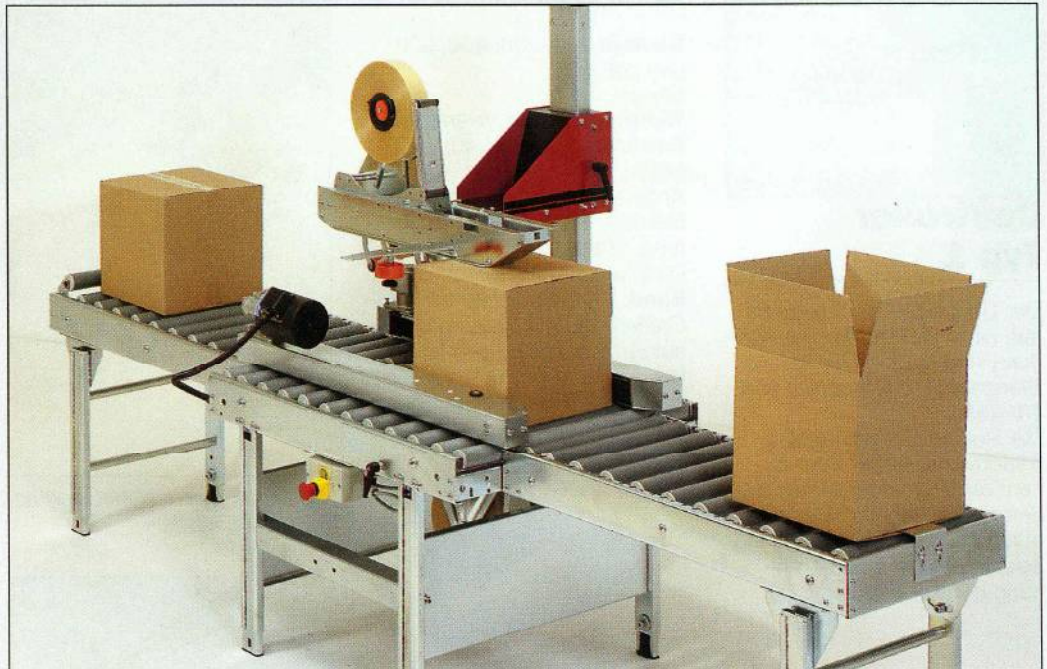
Das Inline System gewährleistet einen effektiven Arbeitsplatz. Das ganze System läßt sich mit Rädern montieren und je nach Bedarf im Betrieb verlagern.
