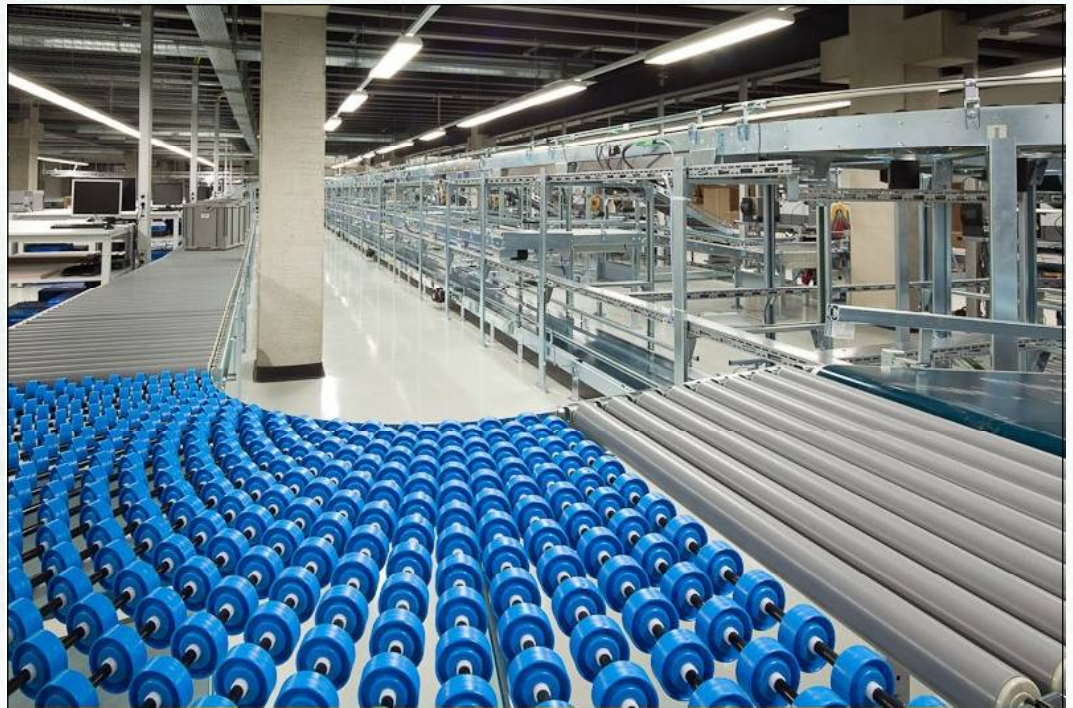
Flexibahnen lassen sich leicht in die gewünschte Position schwenken bzw. drehen.
