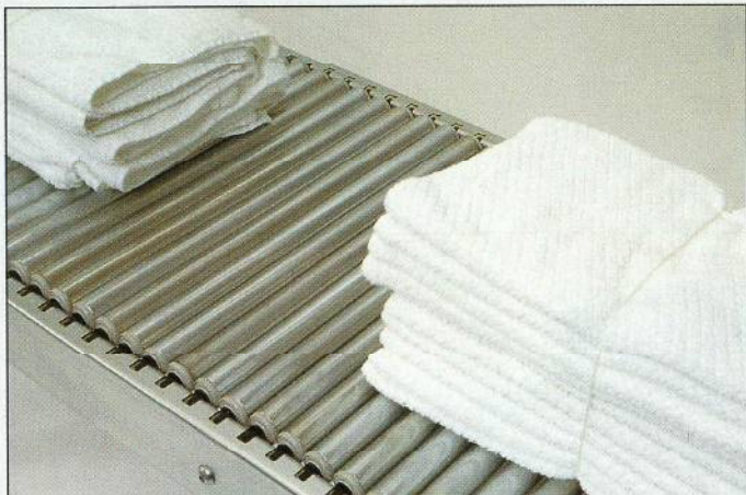
Feste Bahnen mit Ø 28 mm Stahlrollen eignen sich besonders gut für die Beförderung von Gegenständen mit unebenem Boden.
