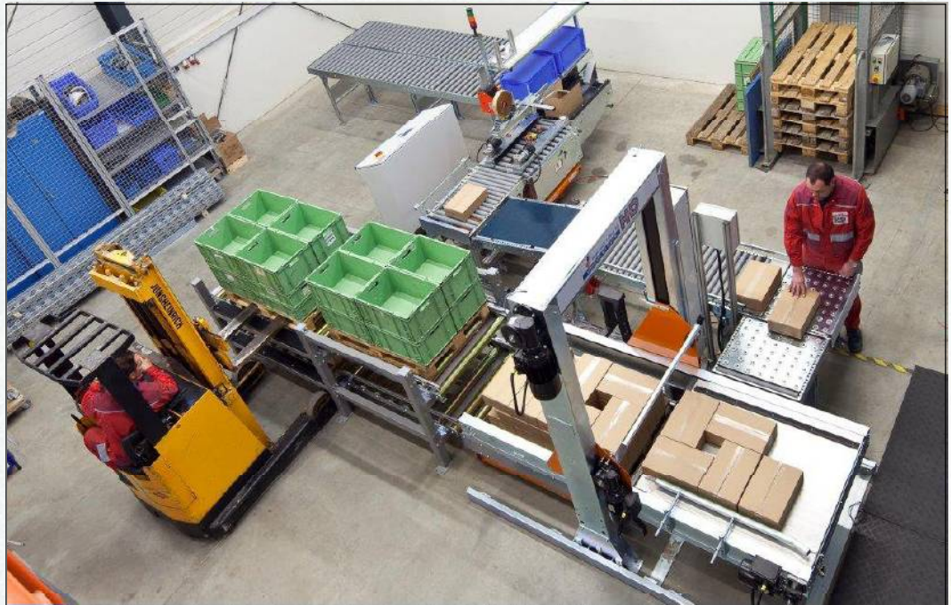
"Übertragung der letzten Lage - in jedem Karton 12 Liter". Ein effektiver und ergonomisch ausgereifter Arbeitsplatz. Der Palettierer ist in sowohl halbautomatischer als auch vollautomatischer Ausführung lieferbar.
