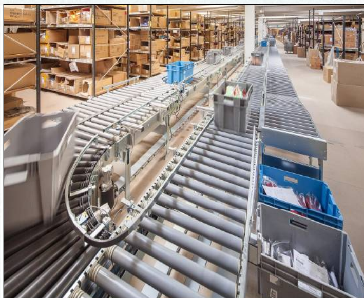
Durch den Einsatz von zwei Antrieben in der Kurve wird die Beförderung von großen und schweren Gegenständen ermöglicht.
