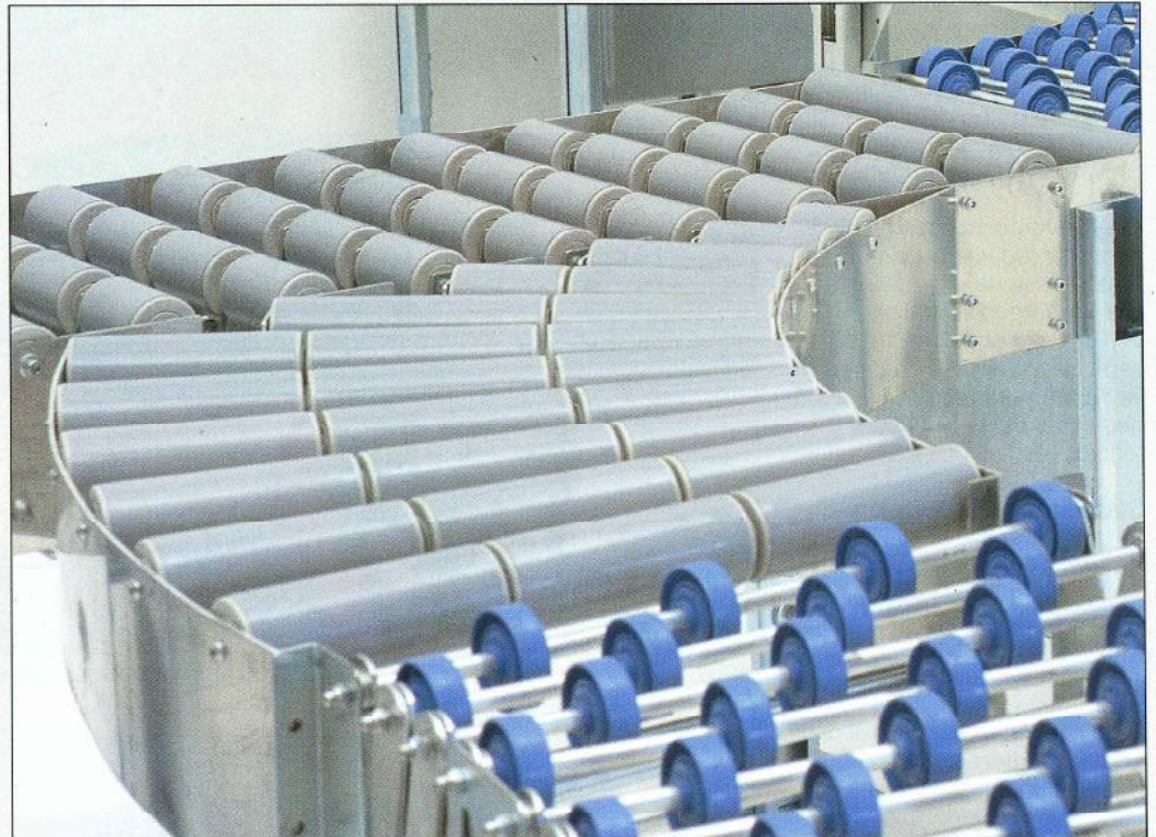
Die pneumatisch gesteuerte Weiche ermöglicht die Trennung verschiedener Fördergüter für je eine Linie.
