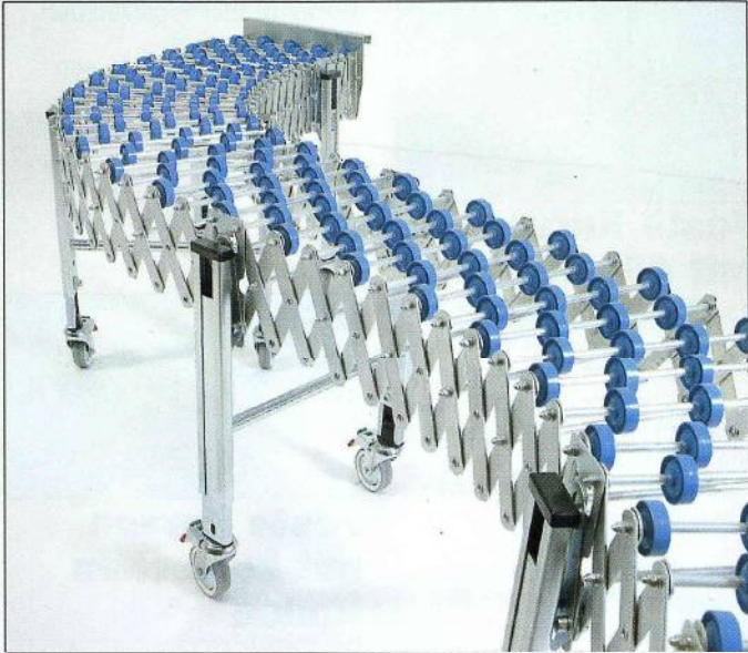
Flexikurven eignen sich dort gut, wo eine schnelle Änderung der Drehung der Kurve erforderlich ist.
