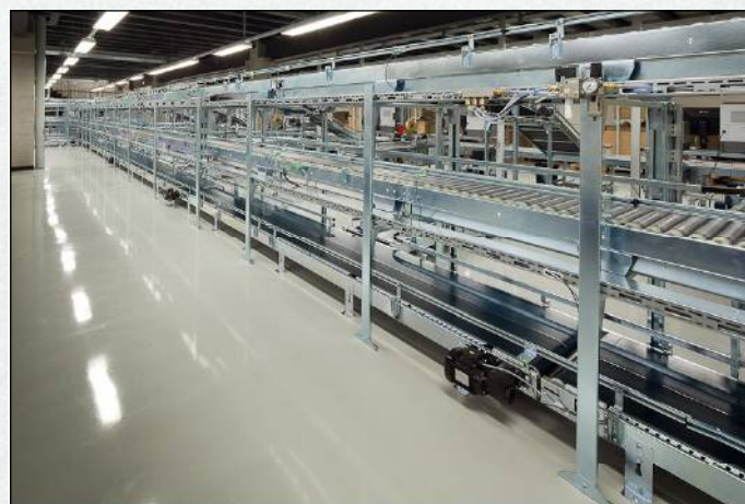
Das System mit Antriebs- und Kupplungssektion ermöglicht den Ausbau der angetriebenen Rollbahn auf eine Gesamtlänge bis zu 12 m bei Anwendung derselben Antriebssektion.
