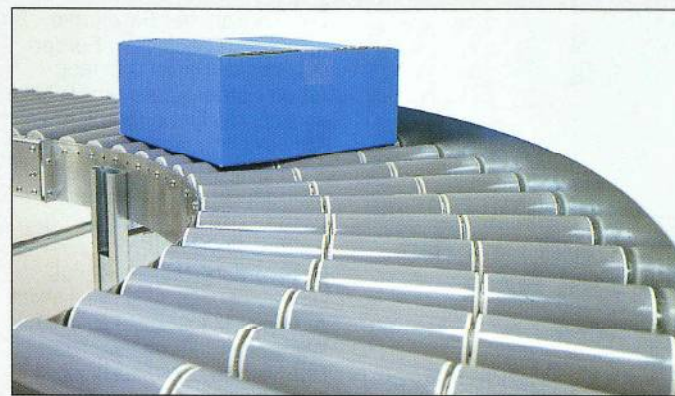
Kurven mit dreiteiligen Rollen eignen sich gut für schwerere Gegenstände sowie für Gegenstände mit einer Bodenkante, wie z.B. Kunststoff-Kästen.
