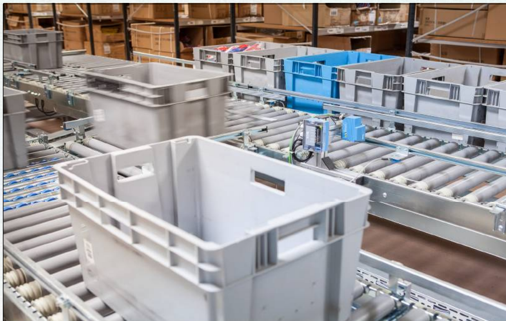
Angetriebene Rollbahnen mit glatten Wangen ohne scharfe Kanten.
