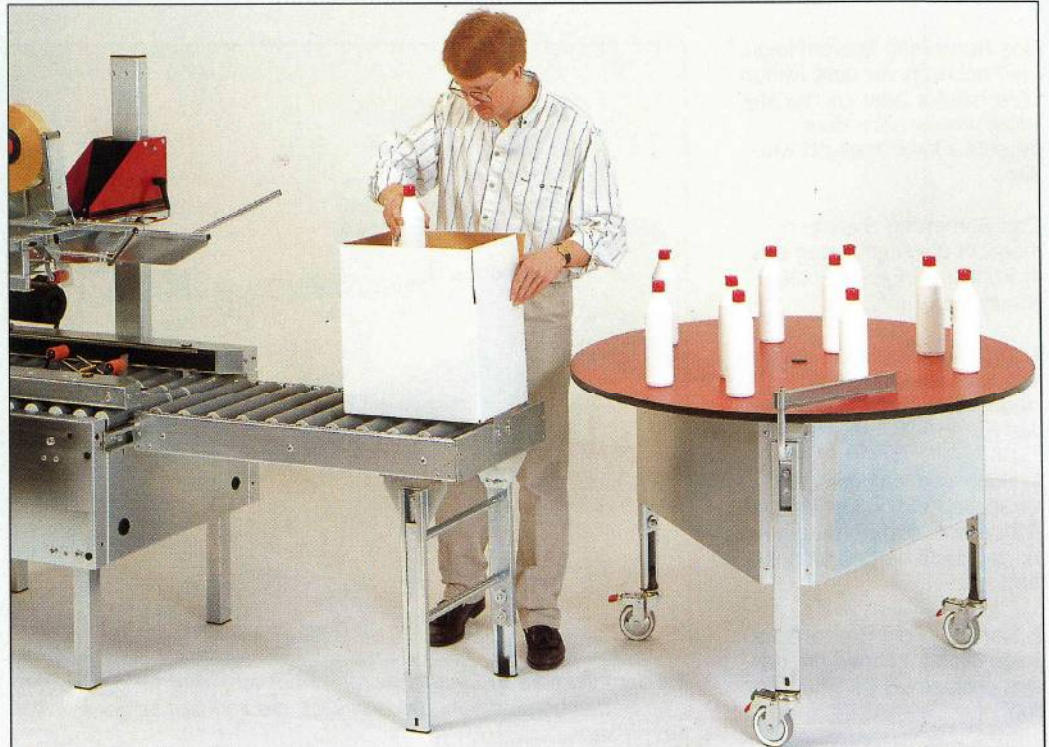
Der Drehtisch eignet sich u.a. gut für das Sammeln von Einzelpackungen, die z.B. in eine Außenverpackung verpackt werden sollen.
