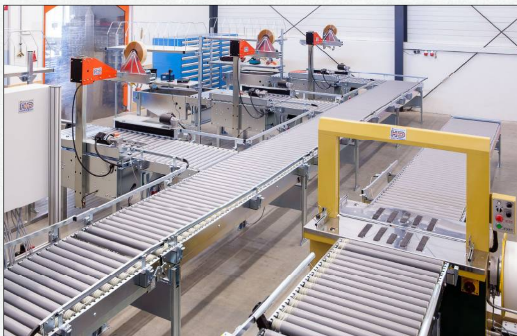
Angetriebene Rollbahnen transportieren fertige Kartons zur Umreifungsmaschine.
