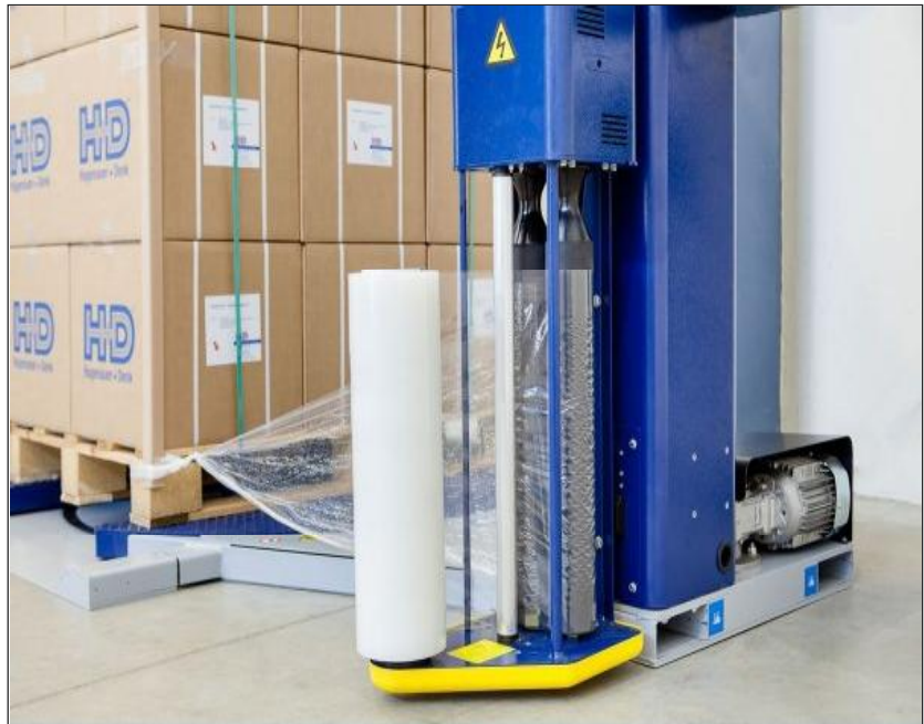
Optional Folien Schlitten mit motorischem Vordehnssystem bis 300%
