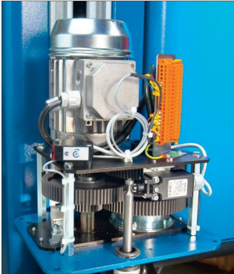
Motorisches Folienvordehnssystem Typ EFV, von 0 % bis 250 % (optional 300 %) über Touchpanel regelbar. Absolut gleichmäßiger und produktschonender Folienauftrag durch integriertes Dehnungsmesssystem.
