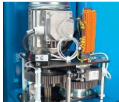
Motorisches Folienvordehnssystem Typ EFV, einstellbar von 0 - 250 %.
