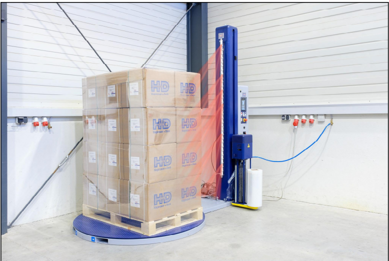
Elektrostatishes Entladungssystem durch Ionisierungsstab.
