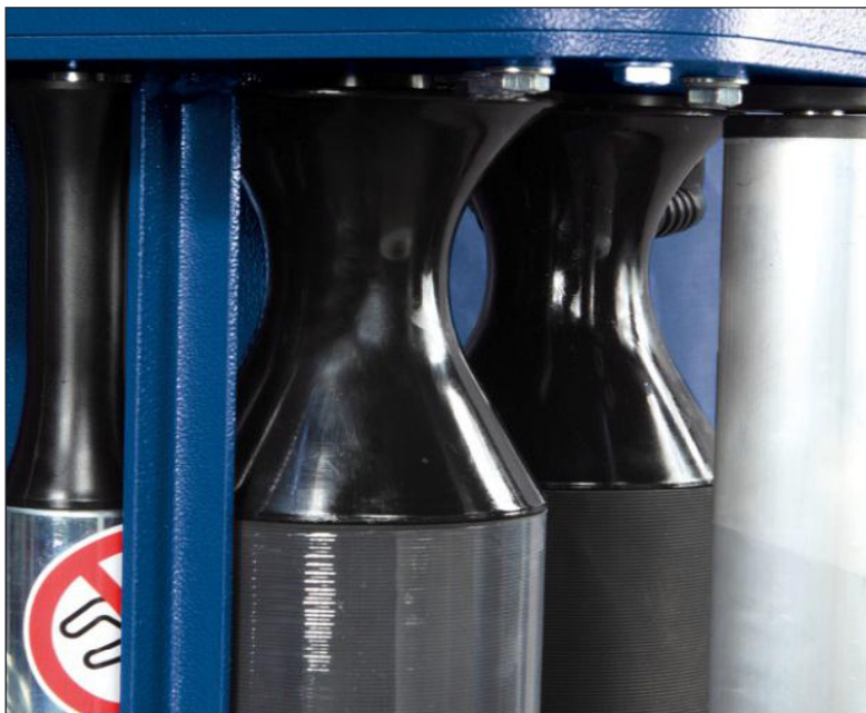
Doppel-motorisches Folienvordehnssystem Typ EFV2, von 150 % bis 400 % über Touchpanel regelbar. Absolut gleichmäßiger und produktschonender Folienauftrag durch integriertes Dehnungsmesssystem.
