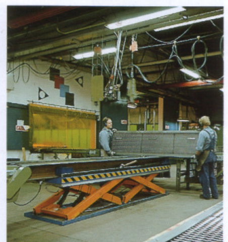
Doppelscherenhubtisch für große Hubfläche.
