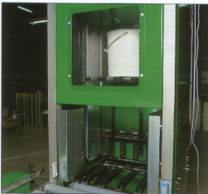
Der Verti wird hier für den Transport von Eimern eingesetzt. Sichtfenster ermöglichen die optische Überwachung.
