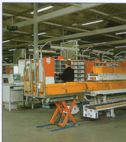
Superflacher U-förmiger Hubtisch mit separatem Hydraulik-Aggregat.
