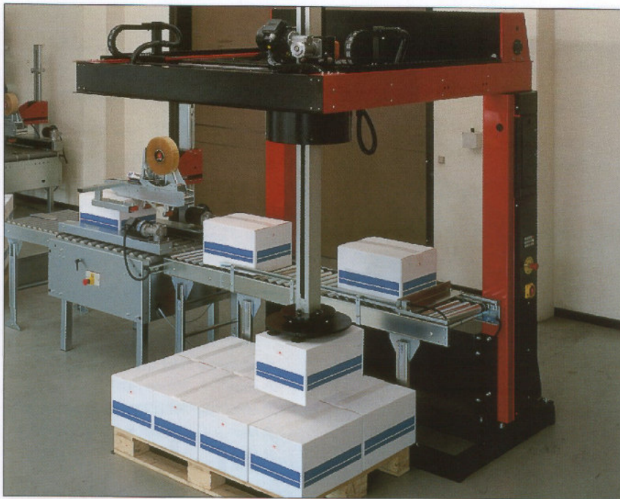
Der vollautomatische, servogesteuerte Roboter hebt volle Kartons von der Transportlinie und plaziert sie auf Paletten.
