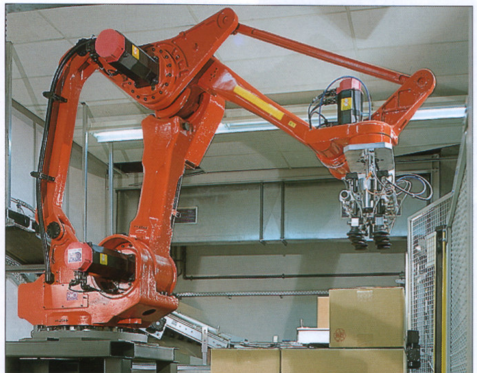
HD-410i in einer vollautomatischen Palettieranlage mit Vakuum-Greifer für Kartons und Slipsheets.
