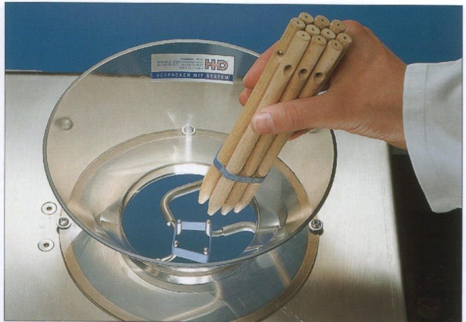
Halbautomatische Bündelmaschine mit pneumatischen Expanderfingern.
