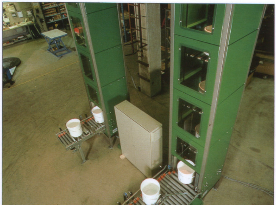
Der Verti transportiert kontinuierlich nach dem Paternoster-Prinzip Fächer, die mittels Photozellensteuerung stets für das Fördergut (Kartons, Kisten, KLTs usw.) aufnahmebereit sind.
