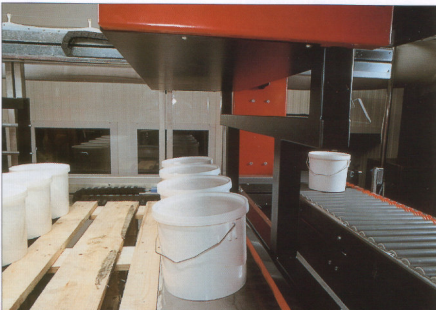
Eimer werden, von der Einlaufrollbahn kommend, der Beladepalte übergeben.
